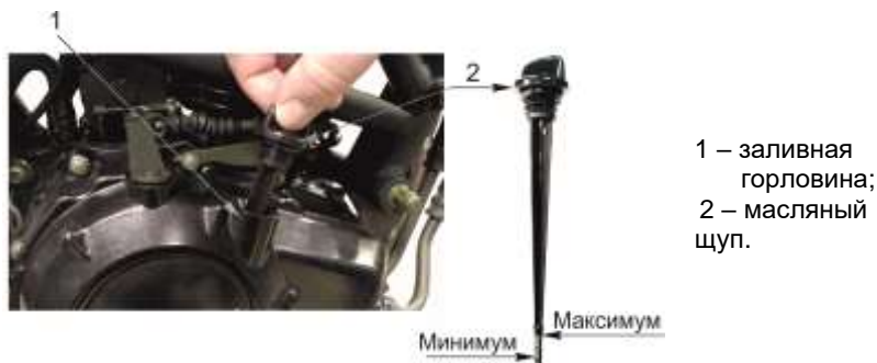
Рисунок 6 – Проверка уровня масла в двигателе
